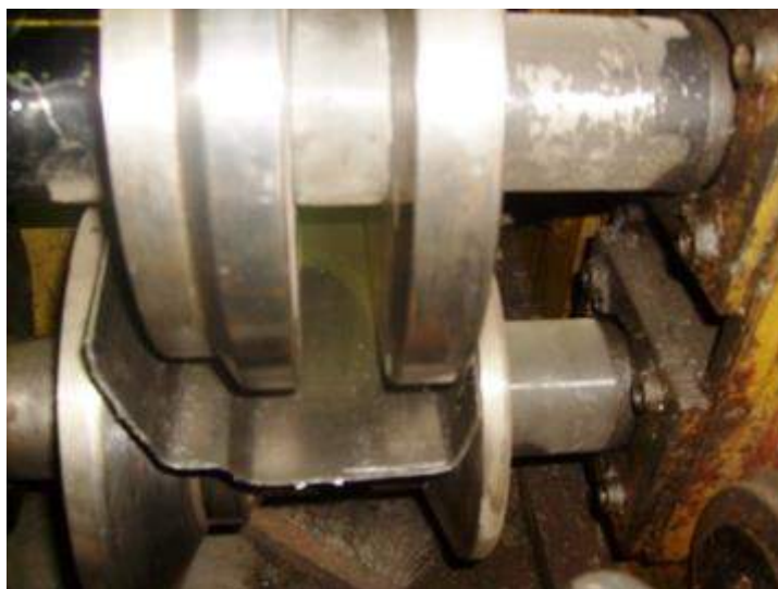
Рисунок 4. Прокатка дверного профиля из «бесконечной» полосы
